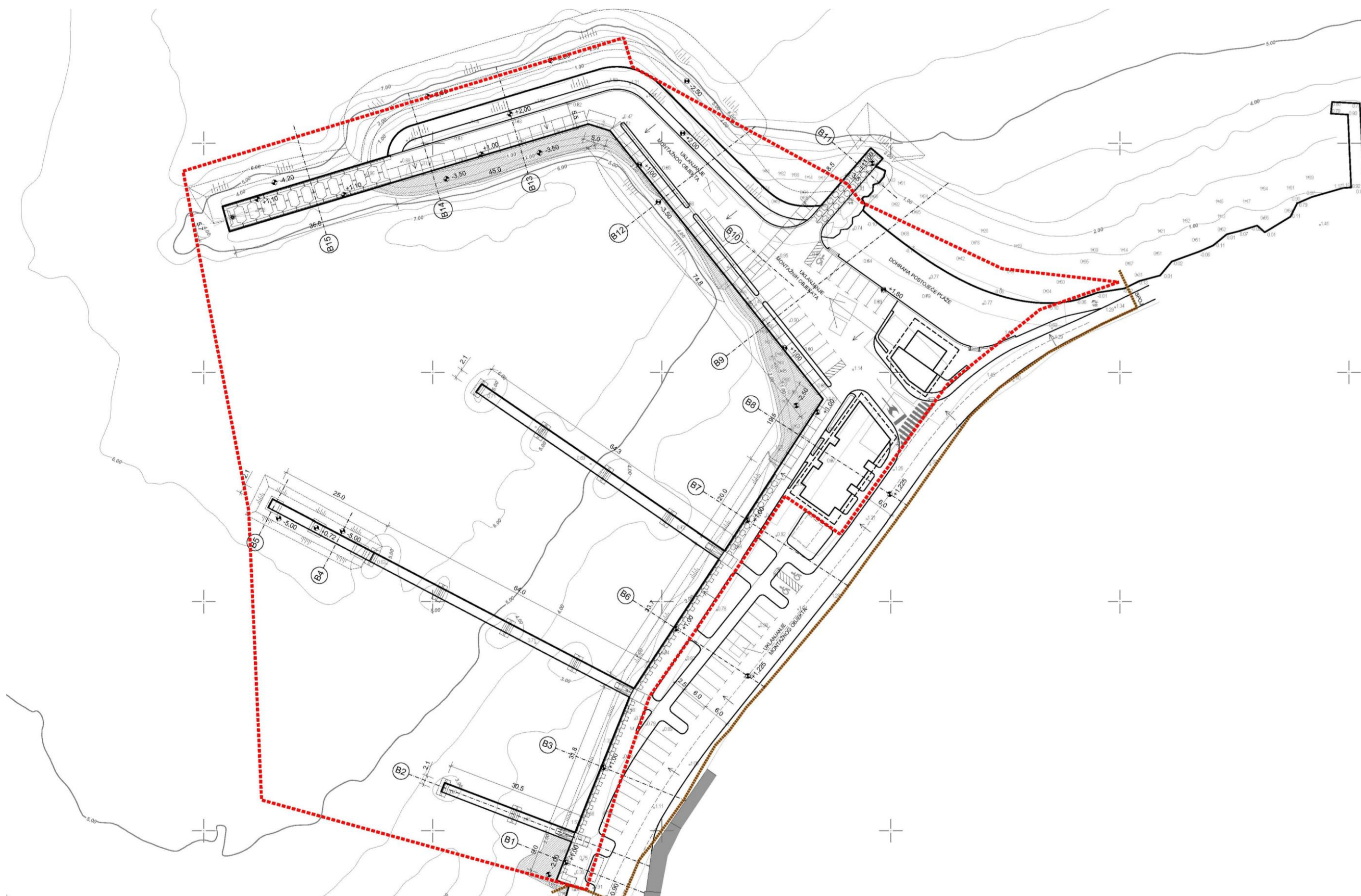
Slika 2.2-9. Situacijski prikaz zahvata s ucrtanim podmorskim dijelom zahvata i označenim položajima popračnih presjeka (izvor: Pomorski projekti, 2018.)
